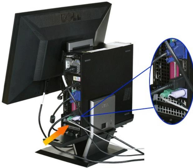
8. Untuk mengatur kabel melalui celah penutup kabel.
